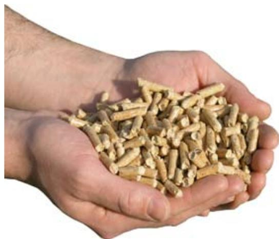
Les granulés sont fabriqués à partir de coproduits (sciures et copeaux) issus de la transformation de résineux dans nos scieries. Ces copeaux et sciures sont simplement séchés, broyés et comprimés directement sur les mêmes sites de production réduisant le transport. La compression des granulés est réalisée sans aucun additif, seuls les composants du bois servent de liant naturel.
